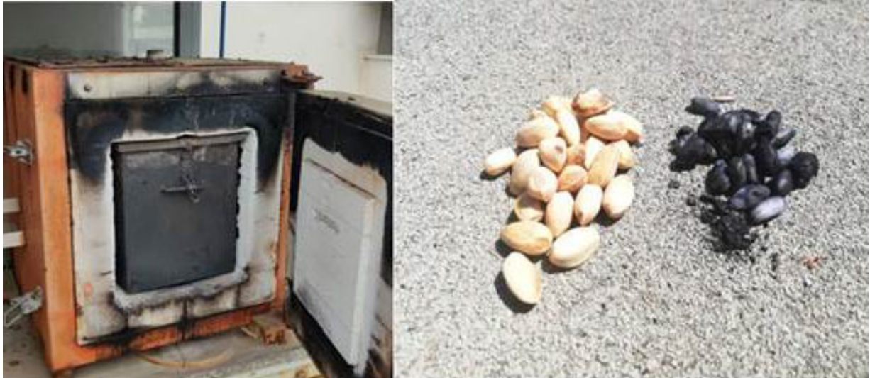
Şekil 1. Biyoçar üretiminde kullanılan kül fırını ve fıstık atıklarının biyoçar öncesi ve sonrası görüntüsü
